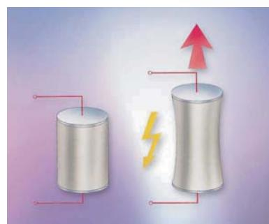
При активации высоковольтным импульсом цилиндрические пьезоэлементы за короткий промежуток времени увеличиваются в размерах на несколько микрометров вдоль своей оси.
