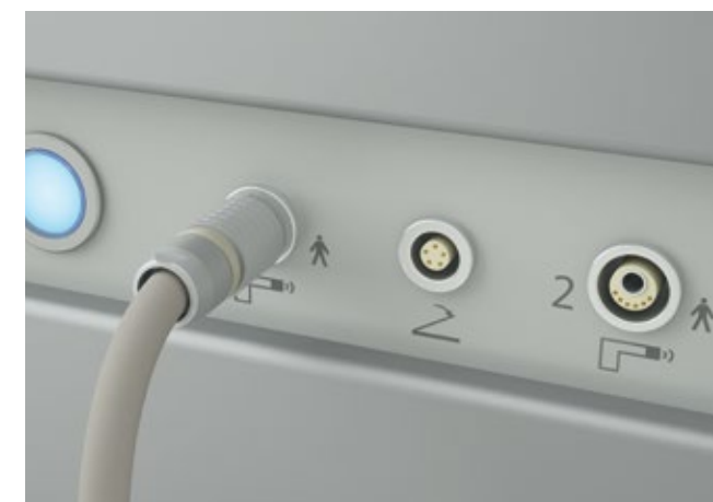
Два разъема для аппликаторов радиальных волн
